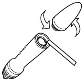
2. Снимите со стилуса пластиковую полосу.
